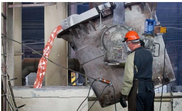
Рис. 6. Заливка расплава алюминия из ковша в миксер
