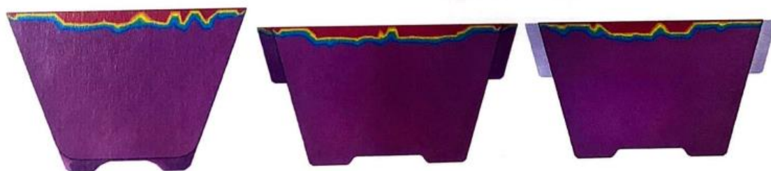
Рис. 12. Сравнение усадочной раковины в поперечном сечении 1/2 L сплава А8 (варианты 1, 2, 3)
