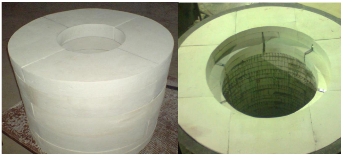
Рис. 5. Футеровка печей современными волокнистыми огнеупорами
