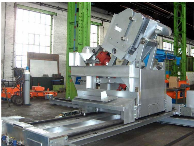
Рис. 3. Машина заливки анодов
