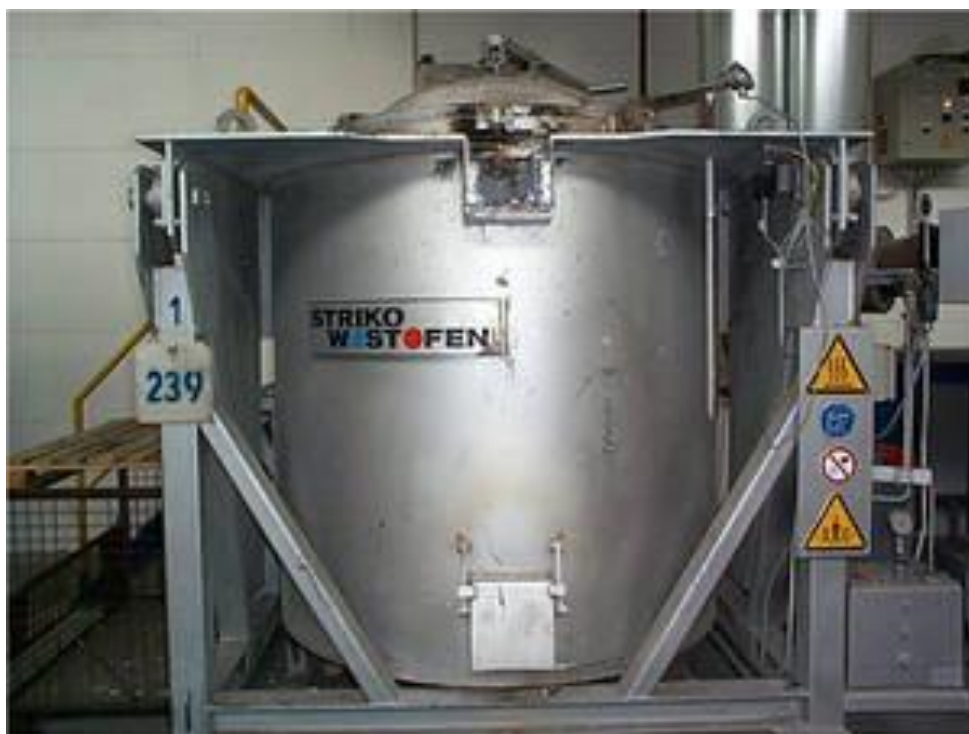
Рис. 1. Электрическая тигельная печь сопротивления для плавки алюминия и магния
