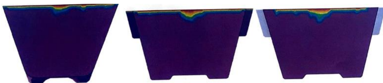
Рис. 16. Сравнение усадочной раковины в поперечном сечении 1/2 L сплава AISi7 (варианты 1, 2, 3)
