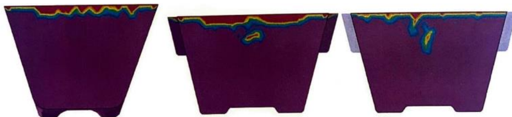
Рис. 14. Сравнение усадочной раковины в поперечном сечении 1/2 L сплава А8 (варианты 4, 5, 6)
