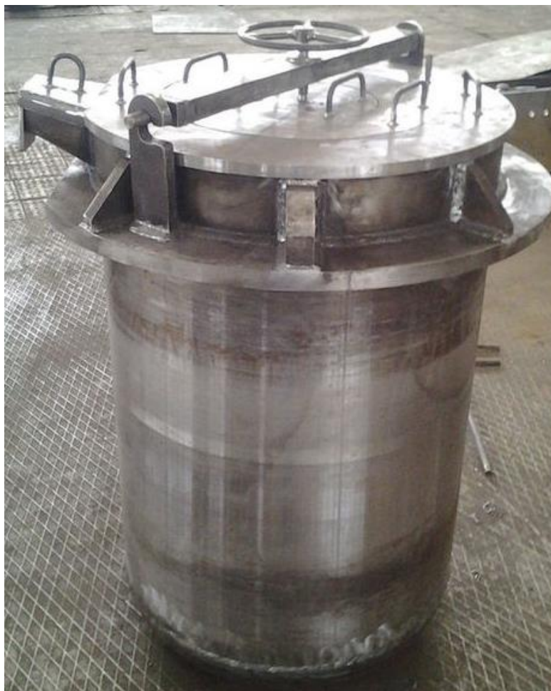
Рис. 4. Стальной тигель для плавки 300 кг алюминия
